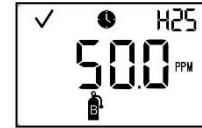
Gasbeaufschlagung für Anzeigetest
